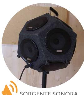
La misura si esegue attivando una specifica sorgente di rumore nell'ambiente emittente e misurando i livelli di pressione sonora in entrambi gli ambienti (emittente e ricevente). Il potere fonoisolante è dato dalla differenza dei due livelli misurati. Pertanto più il valore di  $R_w$  è alto, migliore sarà la prestazione di isolamento acustico della stratigrafia.
