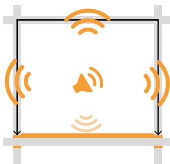
Il sistema costruttivo del massetto galleggiante riduce la propagazione del rumore attraverso il solaio. L'utilizzo di profili resilienti disaccoppianti riduce la propagazione del rumore aereo per via strutturale.
