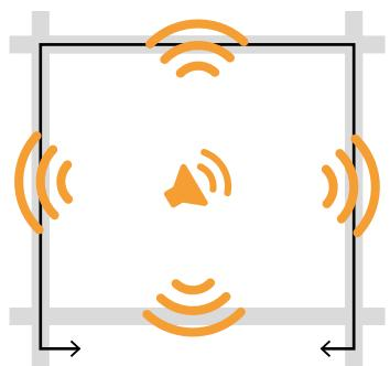
Un rumore di tipo aereo si trasmette agli ambienti adiacenti sia per via aerea sia per via strutturale, seguendo i percorsi rappresentati dalle frecce (trasmissione laterale)
